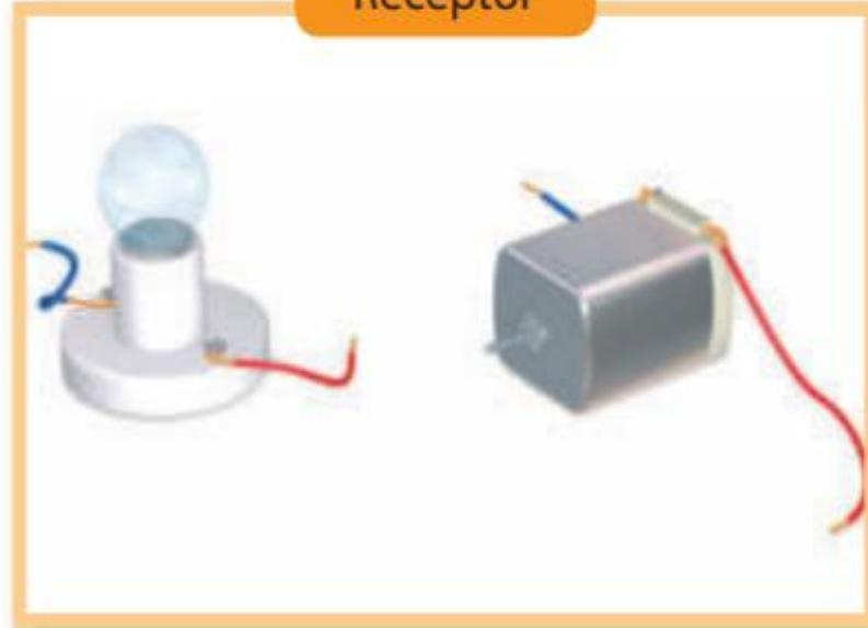
Son componentes fundamentales de un circuito, y a través de ellos se puede transformar la energía eléctrica en lumínica, térmica, sonora o cinética. Son ejemplos de receptores una ampollita, un motor eléctrico o un timbre.
